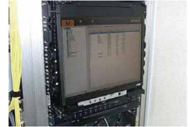
CL5800屏幕/键盘/触控板 可独立抽拉，节省机柜空间
