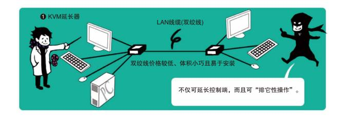
尽管该控制端延长器使用LAN线缆,但并非网络产品。也就是说,您无需了解任何网络知识, 仅连接LAN线缆进行安装即可。但是需注意此特性有别于通过LAN线缆传输的数字信号,因为延 长器传输的是模拟信号。
