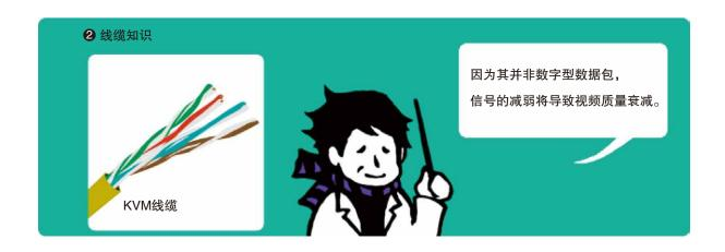
事实上一条Cat 5 LAN线缆通常有8根线。每种RGB色彩需要用2根线传输信号(因RGB由红、绿、蓝三种颜色构成,所以共需6根线),而余下的2根线用于传输键盘及鼠标信号。采用模拟信号时,所延长的传输距离越大将导致传输的效果越差。因此请注意,如采用高品质LAN线缆或具有画面补偿功能线缆,则可提供更完美的视频质量。
