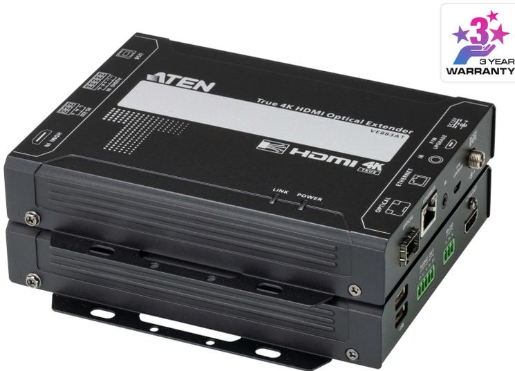
VE883A True 4K HDMI光纤延长器包括一发送器VE883AT与一接收器VE883AR，通过一条双头光纤线材，即可将高达4096 x 2160 / 3840 x 2160 @ 60 Hz (4:4:4) HDMI、音频、USB 2.0、IR、RS-232、与Gigabit Ethernet信号无损地传输至300m(VE883AK1)或10km(VE883AK2)处。光纤线材不仅可简化笨重的线材安装，更降低电磁干扰EMI (electromagnetic interference)与射频干扰RFI (radiofrequency interference)。VE883A采用ATEN独家FarSmooth技术，同步来源信号和输出信号的画素频率，即便在超长距离传输下，仍可确保信号稳定流畅不卡顿。
