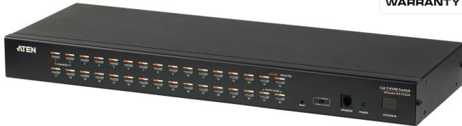
KH1532A KVM多电脑切换器让IT管理者从单一KVM控制端(PS/2或USB接口)访问与控制多达32台服务器；另外，可通过菊式串接的方式，串接高达31台KVM多电脑切换器，便能从原先单一的KVM控制端管理多达1024台服务器。
