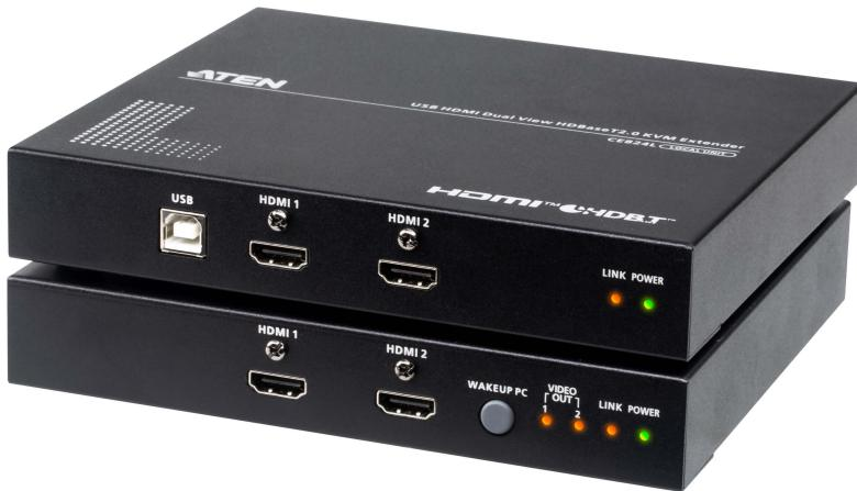
CE824 USB HDMI双显示HDBaseT™ 2.0 KVM信号延长器采用HDBaseT 2.0技术，通过一条Cat 6 / 6A线材(建议搭配ATEN [2L-29330](#) Cat 6A线材)，即可支持无压缩双显示HDMI视频影像、立体声音频、USB和RS-232信号传输长达100m，且单显示支持分辨率高达4096 x 2160 @ 30Hz (4:4:4) /双显示支持高达1080p，让用户可于远程进行键盘鼠标屏幕等操作。若启用长距离模式，CE824可将1080p HDMI信号及其他信号延伸150m\*。CE824安装布线简易且支持机架安装，让系统配置与空间利用更有效率，对于需要高质量的多种信号延伸和远距离KVM控制的应用，例如控制中心、金融和银行业、生产制造和工作站远程操作等场景，CE824是理想的解决方案。
