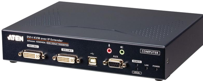
KE6940A 为一款以 IP 为主的高性能 KVM over IP 信号延长器，提供一个连接到计算机的发送端 (KE6940AT)，以及一个从不同位置提供控制端访问的接收端 (KE6940AR)。KE6940A 可通过内部网络从远程 USB 控制端 (USB 键盘、USB 鼠标、DVI 屏幕) 访问计算机系统，用户可将计算机放置在与工作站隔离、安全且温控的环境。
