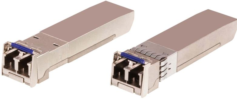
2A-142G单模光纤10G SFP+收发模块(10km) 是专为满足10GbE网络环境建置需求所设计，可以应用在连接以太网络线与网络交换器的SFP+端口。2A-142G提供距离达10km的10GbE联机能力。此收发模块具备热插入及标准双芯接头设计，并支持1310 nm波长的单模光纤(SMF)传输模式，与兼容的网络交换机搭配使用，可协助您打造经济实惠且高效能的网络环境。
