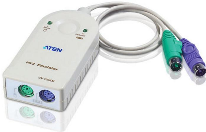
只要将CV100KM插至任何电脑，其内部微型处理器将会仿真一键盘与鼠标信号，此让用户可以在无实体的键盘与鼠标连接下，仍可正常地操作及开启电脑主机。
