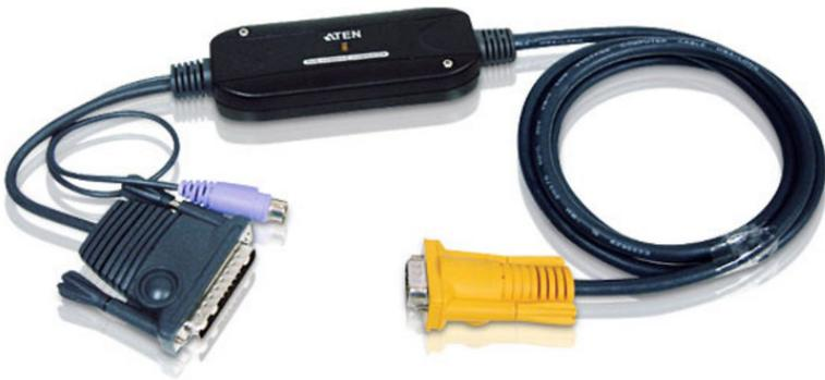
CV130A是专为SUN主机系统所设计的信号转换器，可与KVM切换器搭配使用。两者均内建支持SUN主机系统的13W-3 影像输出及Mini Din-8 键盘&鼠标信号连接端口。
