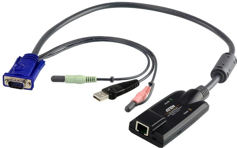
KA7176为USB接口且支持虚拟媒体与音频功能的电脑端模块，可连接KVM切换器至电脑的视频及USB鼠标与键盘连接端口，其外型轻巧为新一代的USB电脑端模块 - 优异信号补偿及延迟时滞(Delay Skew)同步化技术可提供良好视频质量。
