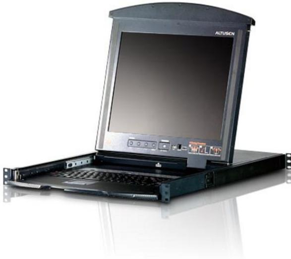
KL3116T双滑轨触控屏幕KVM多电脑切换器整合了LCD控制端与KVM(键盘、显示器、及鼠标)多电脑切换器，其支持USB与PS/2双接口，可安全存取连接的16台服务器。该方案整合了可独立抽拉的17英寸触控式LCD显示器、以及键盘与鼠标触控板于1U机架空间内，独特的双滑轨设计，能有效节省机房使用空间，管理人员在不需使用键盘的情况下，可将键盘/鼠标触控板推回机架内，仅留下LCD显示器持续监看服务器运作状态。
