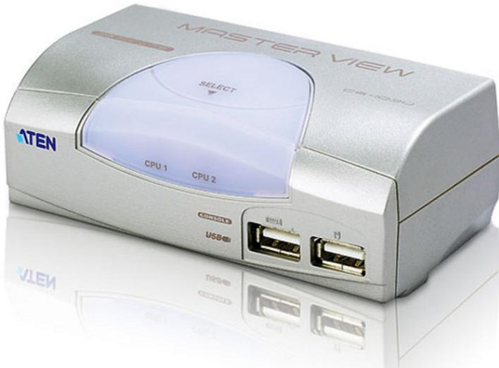
CS102U 为内建USB接口的KVM切换器，提供一组控制端管理2台服务器电脑主机，并让电脑主机共享后端2组USB外围装置，用户也可通过前面板上切换按键。这是单一控制端管理多台电脑的理想解决方案。
