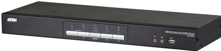
CS1644A是一款整合4端口KVM多电脑切换器和2端口USB集线器的4端口USB DVI双屏幕KVMP™ 多电脑切换器，可应用于多种领域。此产品可菊式串接两台CS1644A，支持四重显示功能。
