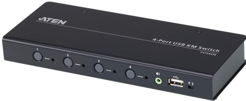
CS724KM 为一台 4 端口仅需USB 键盘/ 鼠标接口连接的滑屏快切多电脑切换器。使用者只需通过单一组键盘、鼠标控制端即可快速切换操作 4 台电脑。如果两台 CS724KM 通过菊式串联方式连接，使用者便能通过单一控制端最多切换操作 8 台电脑。
