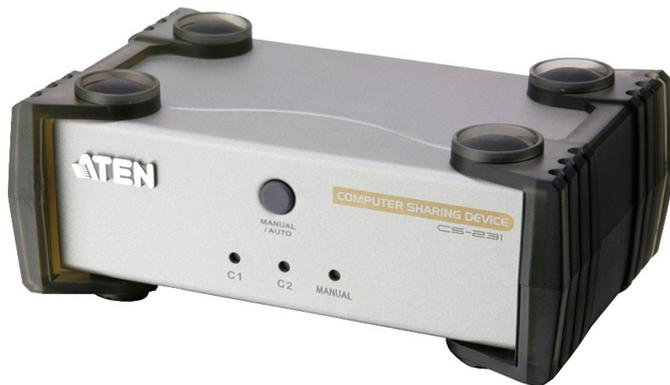
CS231为一功能强大、通过高效微处理器以控制电脑主机分享功能的设备。此款多人单工设备可供两位使用者通过自己的控制端(显示器、键盘和鼠标),分享使用同一台电脑。CS231支持USB接口的控制端及PS/2与USB接口电脑。
