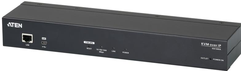
ATEN的新款单口电源KVM over IP 切换器KN1000A可让服务器或未内建over IP 控管功能的传统KVM 多电 脑切换器拥有远程控管的功能。其可让操作者无需到场进行例行IT维修，即可从远端使用浏览器、Windows 或Java架构的应用程式监控及访问电脑，并支持至BIOS 层级的检修故障。此外，若网络断线，KN1000A可 支持频外访问并有外部数据备份资料。
