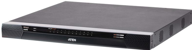
KN4024VB KVM over IP切换器提供远程电脑管理系列方案，用户可通过网络监视及访问数据中心的所有信息。KN 系列产品支持高画质视频分辨率达FHD 1920 x 1200、2倍速的虚拟媒体传输速率，并符合FIPS 140-2 level 1安全性认证的密码模块检测标准，在FIPS模式下可使用经FIPS 140-2认证的内嵌式OpenSSL密码模块。i 备双网络适配器，可以确保持续的机房与数据中心服务，提供全天候的高可靠度。通过WebClient / JavaClient\*，KN系列产品可在异地的控制端进行KVM-over-IP远程访问，使用上更加便利、适于管理。ATEN亦提供一款iOS APP – PadClient，通过其直观的用户接口，用户可自其 iPad 简单地直接连接至KVM over IP多电脑切换器，同管控服务器与电脑。若需了解更多信息，请造访PadClient网页。
