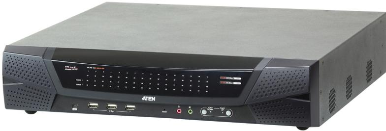
ATEN 第四代 KVM over IP 切换器远程电脑管理系列方案-KN4164V，支持高画质分辨率(Full HD 分辨率 1920 x 1200) FIPS 140-2 level 1 安全性认证以及2 倍速的虚拟媒体传输速率。该方案提供带外管控功能，包括支持外接调制解调器- 当网络断线时可以由电话联机执行BIOS 层级的问题排除。
