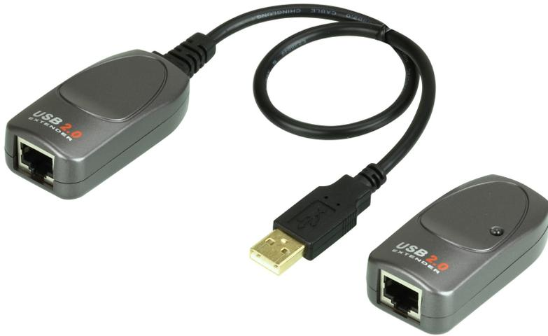
UCE260通过使用以太网线，可轻松地将USB信号延伸至60米；此外传输速率最高达480Mb/s，并且向下兼容至USB1.1(12Mb/s)及1.0(1.5Mb/s)设备。无需任何设定及安装驱动程序，即可突破传统USB的距离限制，延长USB周边设备或集线器与电脑之间的距离达60米。
