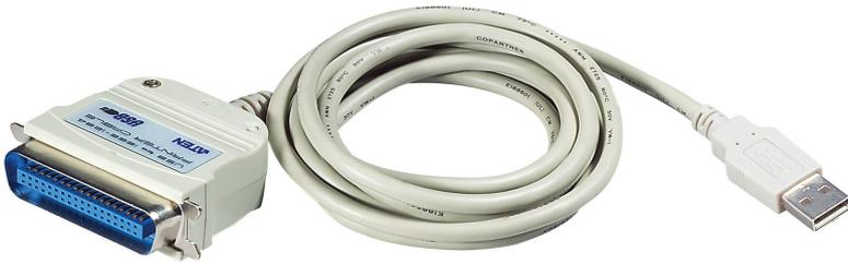
UC1284B为USB转打印机并行端口连接线, 可让支持USB接口的个人电脑、笔记型电脑和掌上型运算设备通过USB连线使用配备并行端口的打印机以进行列印, 并提供远超过标准并行端口速度的12Mbps资料产出。
