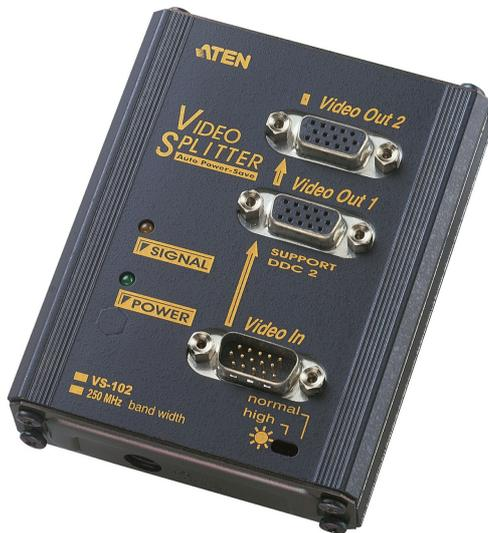
VS102 视频分配器能将所接收的视频信号，通过复制成2组250MHz的信号输出，并可通过影像增益调节钮来增强信号，其传输距离可达65m。
