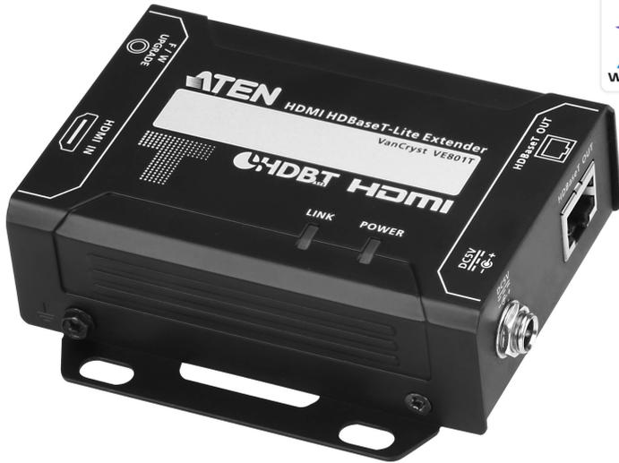
VE801T为一款HDMI HDBaseT-Lite的信号发送器搭配使用HDBaseT接收器，通过一条Cat 5e/6/6a线缆能延伸HDMI信号长达70米，并支持HDMI(3D、深色、4K)、Dolby数字5.1、DTS HD音频及兼容于 HDCP规格。VE801T机壳和壁挂孔一体成型的设计能轻松让机器安装于任何地点。侧边凹槽设计可防止手滑，避免摔落机器，并且位于机器上方或侧边的LED指示灯可易于辨识。VE801T适用于数字娱乐中心或任何安装延伸距离架构中需要更高视频分辨率的环境。
