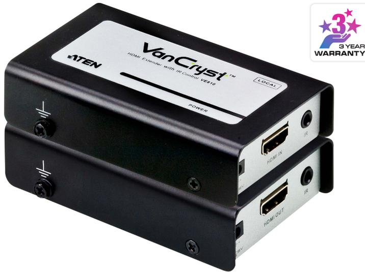
VE810 HDMI影音延长器采用两条Cat 5e线缆, 可延伸HDMI信号来源设备与HDMI显示设备之间的距离达60m远。VE810搭载红外线信号收发功能, 可通过红外线通道从远程控制本地HDMI信号来源, 或从本地控制远程显示设备。
