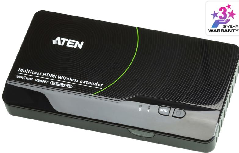
VE849T组播无线信号发送器搭配VE849R使用，延长HDMI来源设备与HDMI显示设备的距离长达30米。通过轻松无线连接两组HDMI来源设备、一组本地高清电视和多达四台信号接收器(与高清电视相连接)，可呈现清晰的画质，支持全高清1080p视频流，5.1通道Dolby数字音频和3D技术。红外线遥控器允许您在接收端切换HDMI来源设备，并且能够同时观看一组本地和四组无线连接的高清电视。
