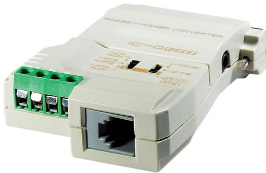
IC485S可以轻易地在RS-232与RS-485/RS-422两个标准中转换，彼此间的距离可达1200m；最多可以有32个接收器串在一起。
