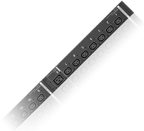
ATEN宏正推出NRGence新一代绿能电源分配器(eco PDU)，能够有效提高数据中心电源使用效率。NRGence PE9324 eco PDU电源分配器为支持24组AC电源插座的智能型电源分配器，并提供各种IEC插座配置。先进的PE9系列产品为重要负载设备提供专属8/14-插座回路，且具备NRGence的主动过载保护功能，当电流过载时，能够自动切断导致过载的最后一个接入的插座电源。
