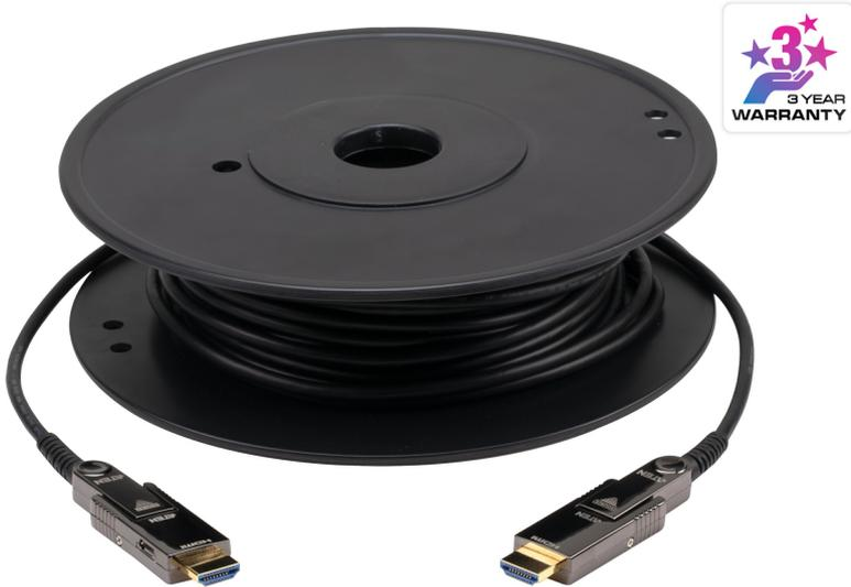
ATEN VE7833A光纤线材使用AOC技术，将来源输入信号与光纤信号相互转换，以提供优化的高带宽传输。此系列线材具抗电磁干扰特性，支持高达 True 4K 的分辨率长度达 30 公尺。此系列线材符合 HDCP 2.2 规范和 HDMI 标准，包含 3D、色深及高达18 Gbps的数据传输率。而音频表现，本系列支持杜比TrueHD和DTS-HD Master Audio，以确保高质量、无失真的音频传输。VE7833A 支持以太网通道功能(HEC)，通过本线材，即可传输音频号与以太网数据，让用户享受具连网功能影音产品的全方位应用。此外，此系列亦支持音频回传通道(ARC)，让音源能往返于电视与扬声器间，进而减少电视与外部家庭剧院系统或长型音响间的线材数量。
